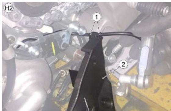
**TABLE I - POSITIONING THE R&W CABLE FROM THE ENGINE WIRING HARNESS**
