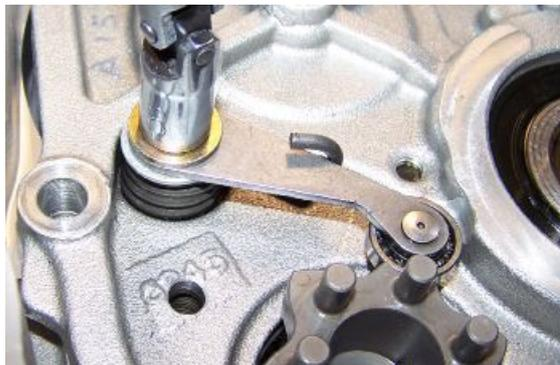
**GEARBOX CONTROL ROD ROLLER CAGE, CLUTCH SIDE**
